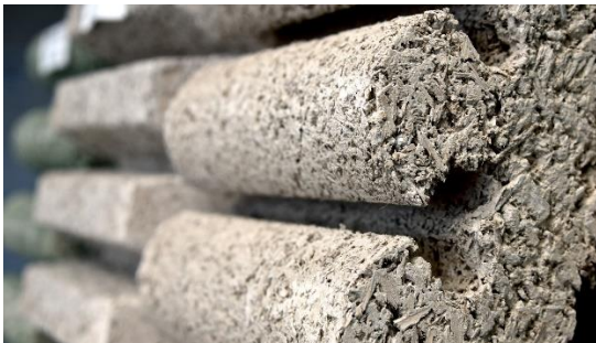
Die poröse Oberflächenstruktur von Holzbeton wirkt in Verbindung mit der Formgebung der Absorber hochgradig lärmabsorbierend.
