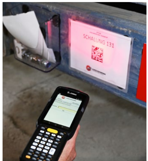
Produktion der Gleistragplatten für die Koralmbahn: Im MABA-Stammwerk Wöllersdorf werden alle wesentlichen Produktionsschritte bis hin zum fertigen Produkt von den Mitarbeitern mit Handscannern dokumentiert.
