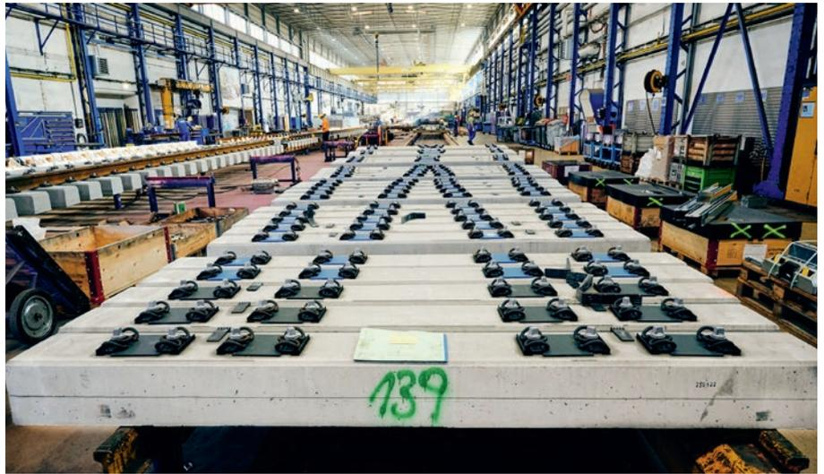
**Zusammenbau in Zeltweg:** Die TSF-A Weichenschwellen werden an das Weichenwerk des TSF-A Joint-Venture-Partners voestalpine Turnout Technology Zeltweg GmbH geschickt, wo sie in einer der größten Montagehallen der Welt zu fertigen Weichensätzen zusammengesetzt werden. Von dort aus werden sie per Bahn nicht nur in Österreich versandt, sondern gehen auch in eine Reihe von Exportmärkten.
