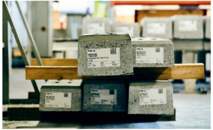
**Präziser Zuschnitt der Weichenschwellen:** Die vorgespannten Weichenschwellen werden – wie auch die Streckenschwellen – nach dem Entschalen auf das erforderliche Maß zugeschnitten. Da die Längen bei den Weichenschwellen variieren und zudem fast jede Weiche in gewisser Weise ein Unikat ist, gibt es im Schwellenwerk der TSF-A in Sollenau insgesamt bereits rund 45.000 unterschiedliche „Artikel“.
