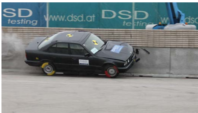
Bild: Die neuentwickelten „SILE&SAFE®“-Elemente aus haufwerksporigem Leichtbeton kombinieren verlässlichen Anprallschutz mit lärmabsorbierender Oberfläche und sind nach EN 1317 getestet und für das niederrangige Straßennetz zugelassen. Abdruck honorarfrei bei Nennung: MABA Fertigteilindustrie GmbH
