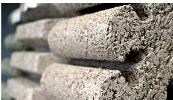
Bild: Die poröse Oberflächenstruktur von Holzbeton wirkt in Verbindung mit der Formgebung der Paneele hochgradig lärmabsorbierend. Abdruck honorarfrei bei Nennung: Christoph Rieger
